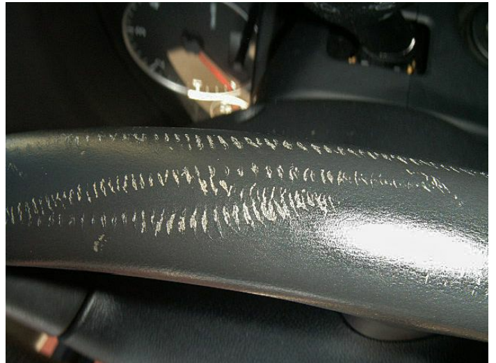
Aufgeraut: Schleifpad verwenden
