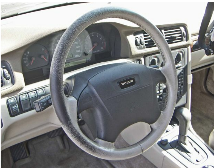
sehr gut und mehrfach entfetten. Sonst hält das Leder Fresh nicht. Dazu Fettlöser-Spray verwenden.
