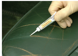
Mit Flüssigleder auffüllen...
